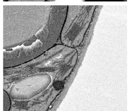
植物样品的超微结构: 拟南芥叶片,使用美国国家显微成像研究中心(NCMIR)开发的制样方法进行包埋。上图为样品在不使用 Focal CC 的情况下进行的成像,下图为在使用 Focal CC 的情况下进行的成像。通过对比可见,在不使用 Focal CC 的情况下图像会受到荷电效应的影响。样品由瑞士苏黎世联邦理工学院的 S.C. Zeeman 教授提供。
