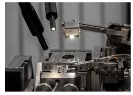
样品置于超薄切片机中后,需要将其向钻石刀靠近。光源使刀具在样品表面的反射清晰可见,依此可以判断钻石刀与样品之间何时已足够接近。
