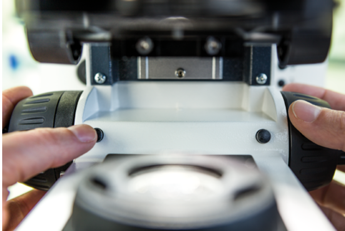
Axioscope 5: Her iki tarafta görüntü almak için Yakalama düğmesi Axioscope 7: Yakalama düğmesi (sağ) ve tabla kontrol düğmesi (sol)
