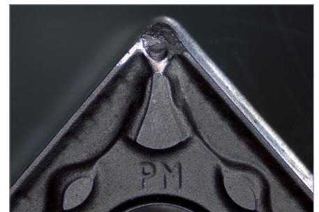
可轉位刀頭，顯示刀具磨損。
