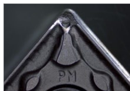
スローアウェイチップ、ツールの摩耗が見られる。 反射光、リングライト、0.8xズーム
