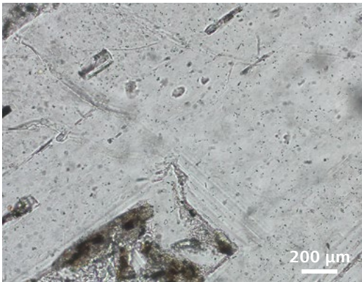
Fluorit, Durchlicht, Hellfeld, EC Plan-NEOFLUAR 5x/0,16 Pol
