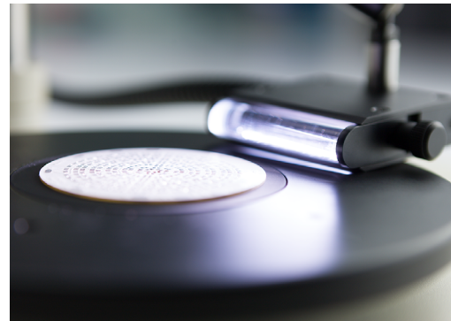
L'éclairage linéaire S forme une surface homogène de lumière rasante. À utiliser pour contraster les structures de surface de grands échantillons plats comportant des zones très sombres.
