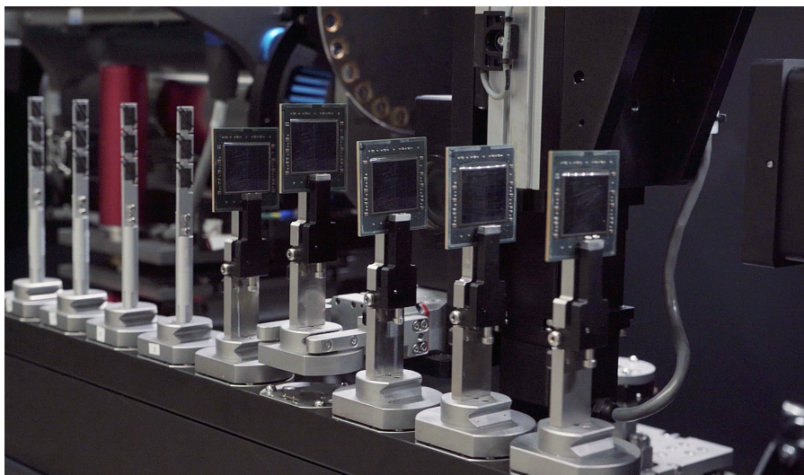
ZEISS Autoloader オプションを使用すると、一度に最大 70 個の試料の連続測定が可能に。
