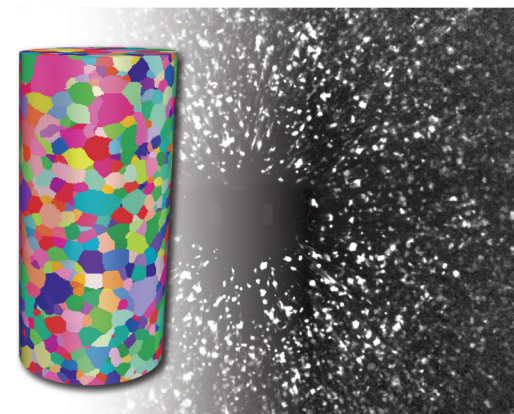
1.0 mm (直径) と 3 mm (高さ) の Armco 鉄試料の 3D 結晶粒マップ。Helical phyllotaxis raster で測定。試料ご提供：Prof. Burton R. Patterson, University of Florida, USA
