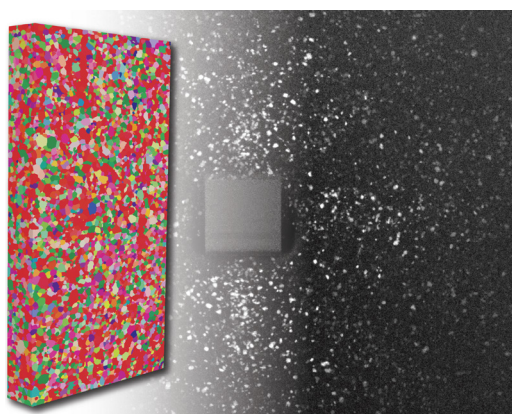
4 mm (RD)、2 mm (TD)、0.5 mm (ND) の AA5657 試料の 3D 結晶粒マップ。Helical phyllotaxis HART で測定。試料ご提供：Dr. Robert Sanders, Novelis, USA
