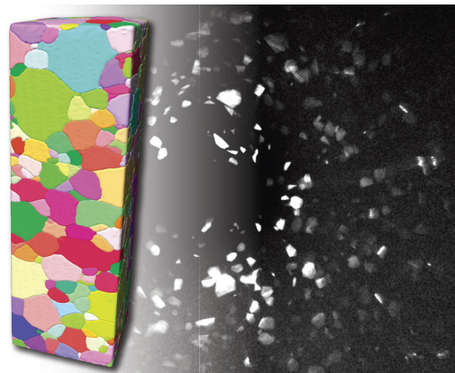
1.0 mm (辺長) と 3.2 mm (高さ) の \beta -Ti 試料の 3D 結晶粒マップ。Helical phyllotaxis で測定。
