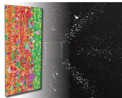
4 mm (RD)、2 mm (TD)、0.08 mm (ND) の極薄配向電磁鋼試料の 3D 結晶粒マップ。Helical phyllotaxis HART で測定。試料ご提供：Dr. Li Meng, China Iron and Steel Research Institute, China
