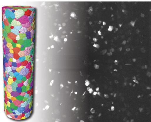
1.1 mm (直径) と 5.1 mm (高さ) の Al-4wt.%Cu 試料の 3D 結晶粒マップ。Helical phyllotaxis で測定。
