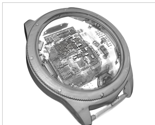
28 μm/voxel でイメージングしたスマートウォッチの 3D レンダリング画像。画像は、ウォッチアセンブリ全体だけでなく、マザーボードや音響部品などの内部の特徴も示す。
