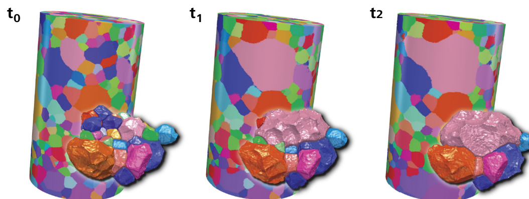
アニーリングの様々な段階でイメージングした Armco 鉄試料の 4D 結晶粒マップ。 t0：最初の状態、t1：880°C で 8 時間のアニーリング後、t2：880°C で 16 時間のアニーリング後。 経時的に 3 つの状態を試料のイメージングをすることで、上部のピンク色の結晶粒の異常な粒成長が確認できます。 ご提供：Prof. Burton R. Patterson, University of Florida, United States
