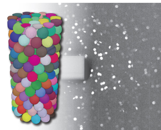
各球の直径 0.2 mm の積み重ねたサファイア球の 3D 結晶粒マップ。Helical phyllotaxis で測定。
