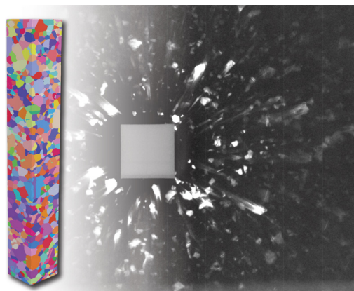
0.66 mm (辺長) と 4.4 mm (高さ) のオーステナイト系ステンレス鋼試料の 3D 結晶粒マップ。Helical phyllotaxis raster で測定。試料ご提供：Prof. Grethe Wither, Technical University of Denmark
