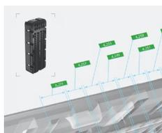
Röntgen-CT-Abbildung und Vermessung eines Baugruppen-Steckers mit ZEISS METROTOM
