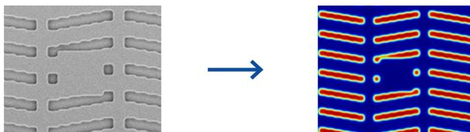
**Fotomaskendefekt vor der Reparatur:** Im linken REM-Bild, aufgenommen mit ZEISS MeRiT, ist ein Defekt in der Struktur zu erkennen. Auf dem Luftbild auf der rechten Seite, aufgenommen mit ZEISS AIMS, ist dargestellt, wie sich dieser Defekt auf der EUV-Fotomaske auf den Waferdruck auswirkt.
