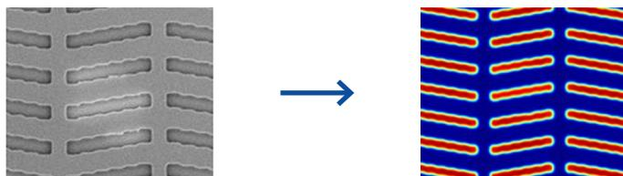
**Nach Reparatur des Defekts:** ZEISS MeRiT ermöglicht die zuverlässige Reparatur und Defektkorrektur von Masken mithilfe der gasunterstützten Elektronenstrahlolithografie (links). Das mit ZEISS AIMS aufgenommene Luftbild (rechts) erlaubt die Prüfung der Reparaturqualität des Defekts.
