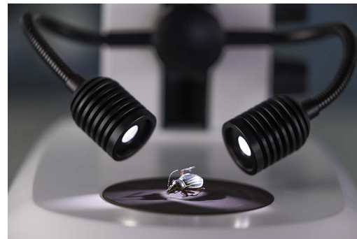
对于在反射光中的样品制备中，双支点照明用自带鹅颈是最佳选择。它创建半阴影效果，形成一个良好的 3D 效果，且阴影不至于过暗。即使操作时手覆盖了其中一支光源，解剖样品时仍能起到照明作用。
