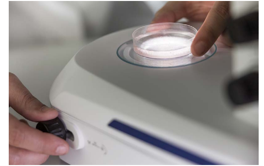
可倾斜可移动反光镜的明场，场，单边暗场，斜照明，还有偏光观察式可选。旋转反光镜从磨砂面到平光镜一面，就可以在弥散和锐利明场之间切换。
