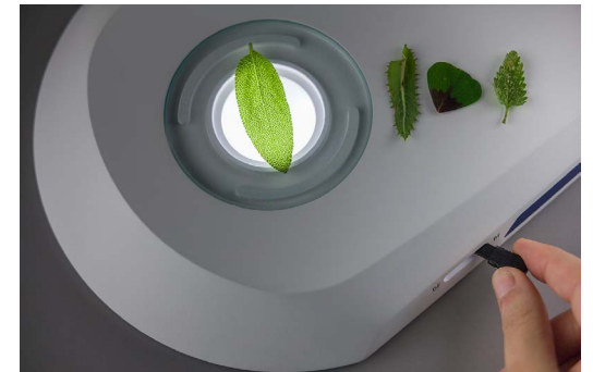
使用平场透射光底座，可用明/暗场观察彩色透明样品。添加起偏/检偏组件来观察，例如，双折射晶体或玻璃或塑料的张力
