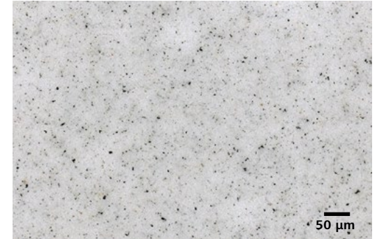
粒子解析、明視野 対物レンズ : EC Epiplan-NEOFLUAR 20x/0.5
