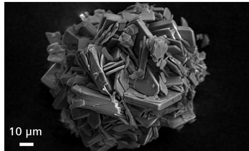
帯電効果を大幅に低減する C2D イメージング（試料：透析患者の経口治療薬として使用されるリン酸結合剤である炭酸ランタン）。
