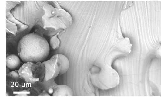
選択的レーザー溶融法によって製造したチタン合金 (Ti-6Al-4V) の表面。完全に溶融している部位と、溶融していない Ti-6Al-4V 粒子と他の材料が認められる。EVO 15 の反射電子検出器を使用してイメージング。試料ご提供：TWI Ltd
