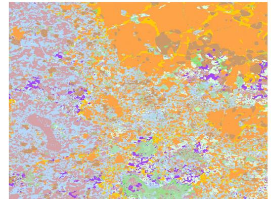
高分解能の鉱物マップ。サドベリーのフレージャー鉱山で採取された Ni-Cu 鉱石。ご提供：University of Leicester, UK
