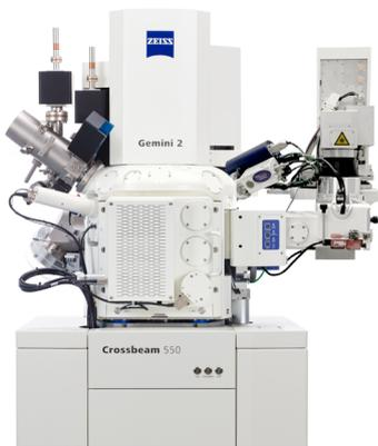
蔡司 Crossbeam Laser 激光聚焦离子束扫描电子显微镜是一款对指定位置进行截面处理的解决方案，可加快封装失效分析 (FA) 和工艺开发。
