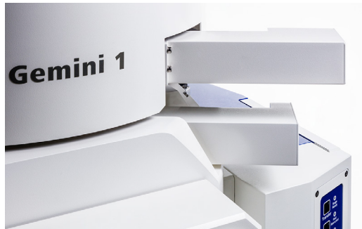
利用两个平行的独特 Inlens 探测器进行样品综合表征。
