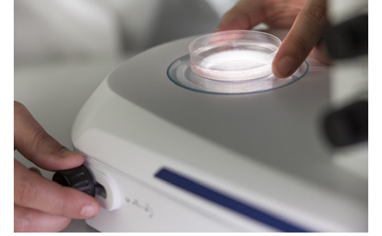
Eğilebilir ve kaydırılabilir aynada aydınlık alan, tek taraflı karanlık alan ve oblik ışık, ayrıca isteğe bağlı seçenек olarak polarizasyon kontrastı vardır. Aynanın buzlu camlı veya düz tarafını çevirin, sonra keskin veya dağınık aydınlık alan kontrastı arasında seçim yapın.
