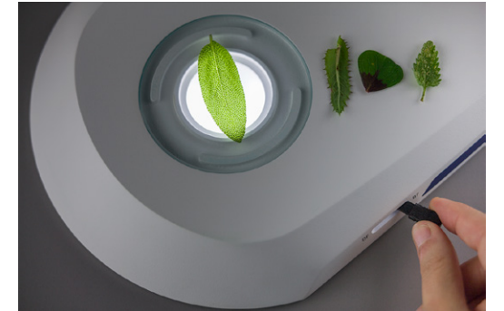
Geniş yüzeyli alt ışığı kullanarak renkli saydam örneklerde aydınlık ve karanlık alanların kontrastını artırın. Örneğin aydınlık alan kristallerini veya camdaki ya da plastikteki gerilmeleri gözlemlemek için polarizör ve analizör ekipmanı ekleyin.
