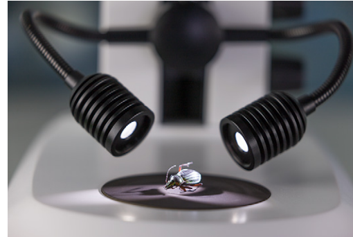
Yansıtılan ışıktaki örnek hazırlama işlemlerinde, kendi kendine havada duran gooseneckler ile çift spotlu aydınlatma mükemmel sonuç verir. Aşırı koyu gölgelere yol açmaksızın, iyi bir 3D derinlik veren yarı gölgeli efektler oluşturur. Dilimleme sırasında, çalışan kişinin eli spotlardan birini kapatsa bile numune aydınlatılmaya devam eder.
