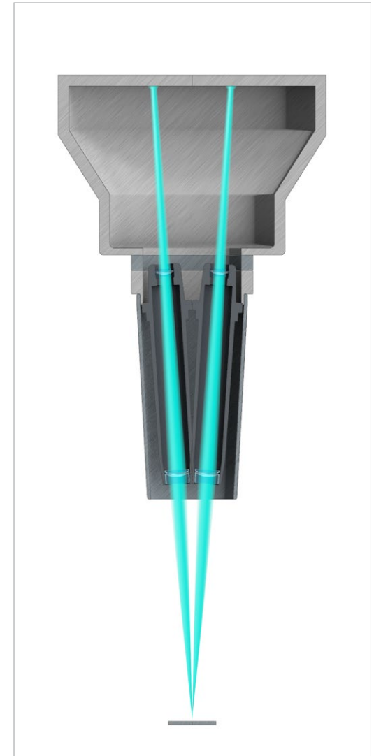
Caminho da luz do feixe de um estereomicroscópio tipo Greenough
