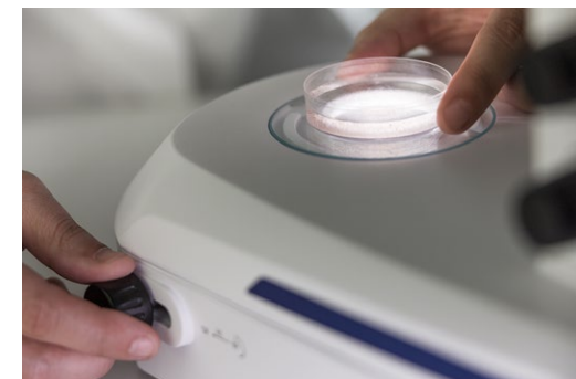
O espelho inclinável e deslocável apresenta iluminação para campo claro, campo escuro unilateral e luz oblíqua – para além de contraste de polarização como uma opção. Gire para o lado fosco e plano do espelho e, em seguida, escolha entre campo claro com um contraste difuso ou mais nítido.
