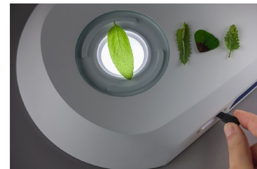
Utilize a base plana com iluminação transmitida para contrastar amostras transparentes coloridas em campo claro e campo escuro. Adicione acessórios para polarização (polarizador / analisador) para observar, por exemplo, cristais birrefringentes ou tensões em vidros ou plásticos.
