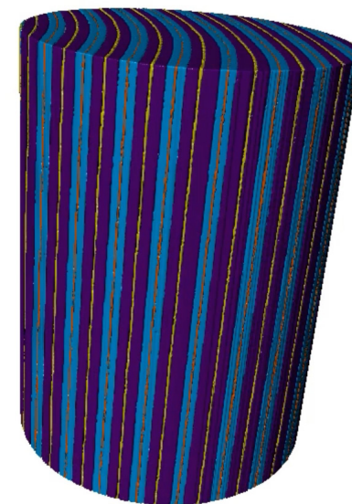
蔡司 Xradia 620 Versa 扫描的 21700 电池三维图像
