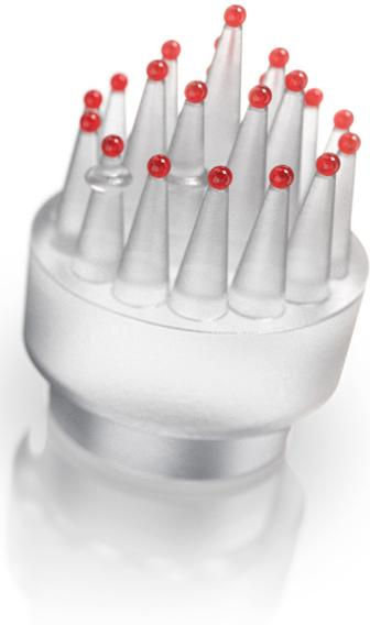
XRМ 检查: 蔡司开发了一种 (多球面) 长度标准, 用于验证小尺寸 CT 测量的精度。根据 VDI/VDE 2630-1.3 指导准则, 用于确定偏差 SD。
