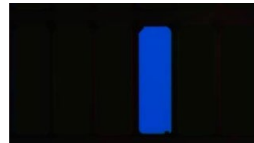
Défaut de sous-pixel clair : Point clair sur un fond noir causé par le sous-pixel bleu à l'état « allumé ».
