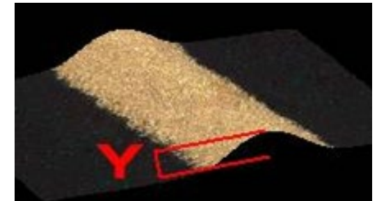
Doigt d'argent : Reconstruction 3D sur cellule solaire en silicium monocristallin ; EC Epiplan-NEOFLUAR 20x/0,50
