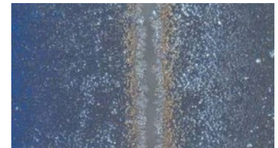
Rainures d'isolation : Rainures d'isolation structurées au laser sur cellule solaire en silicium monocristallin ; EC Epiplan- APOCHROMAT 20x/0,60
