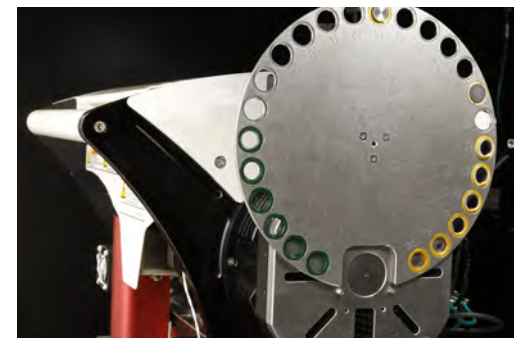
ZEISS Xradia 630 Versa 専用自動フィルターチェンジャー (AFC) には、13 の標準フィルターと、11 のカスタムフィルターのスロットを搭載。
