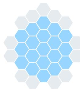
Les données relatives à la concentration et à la diffusion moléculaires sont recueillies par les 19 éléments les plus centraux du détecteur Airyscan. La lecture de détecteurs séparés permet d'effectuer des mesures à des intensités totales (luminosité) beaucoup plus élevées que ne le permettrait le FCS conventionnel.
