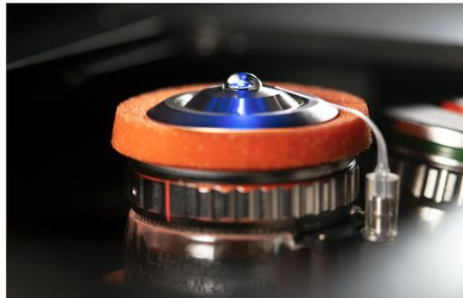
*Le module Autoimmersion automatise l'application des fluides d'immersion pour les objectifs d'immersion dans l'eau. Le fluide d'immersion est appliqué tout en maintenant une mise au point et une position de l'objectif, ce qui permet de ne pas perturber vos expériences.*
