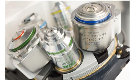
*Grâce aux objectifs autocorr et au logiciel de microscopie ZEN, il est facile d'adapter l'optique de votre microscope à votre échantillon. Vous obtenez un contraste net et un meilleur rapport signal sur bruit, même dans les échantillons les plus difficiles.*
