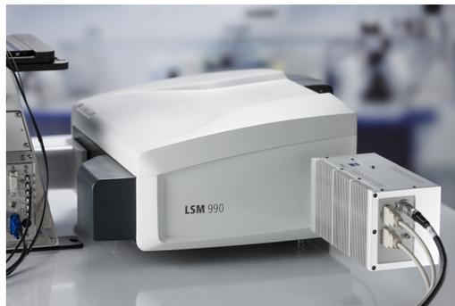
*Ajoutez le module BiG.2 avec ses deux détecteurs GaAsP pour FCS, les expériences de photons-comptage et FLIM\* à votre ZEISS LSM 990.*
