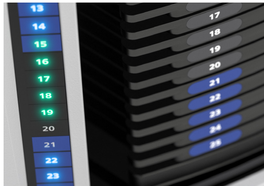
可单次扫描多达 100 块玻片，并为玻片分配不同的扫描配置文件和成像模式。
