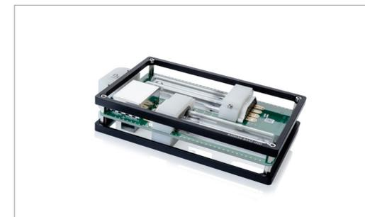
Celldiscoverer 7 には、試料チャンバーを清潔に保つ効果的な機能が備わっています。システムが UV 消毒用のインサートプレートを自動的に認識したら、タッチパネルで消毒ワークフローを開始できます。
