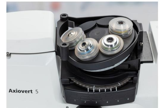
O Aqua Stop II protege as objetivas e outros componentes ópticos dentro do microscópio contra líquidos.
