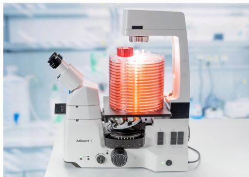
*Use o adaptador opcional de expansão para lidar com grandes pilhas de células ou fábricas de células até uma altura de 220 mm.*
