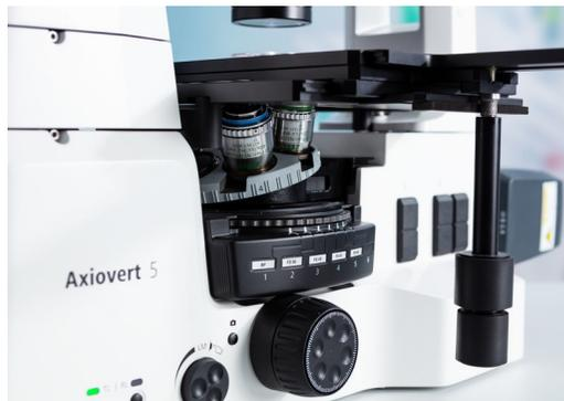
O carrossel de reflexão codificado com 6 posições e a torre de revólver codificado com 6 posições proporcionam flexibilidade.
