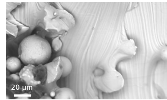
Superficie della lega di titanio (Ti-6Al-4V) additivata mediante fusione laser selettiva, che evidenzia regioni completamente fuse unitamente a particelle Ti-6Al-4V non rivestite e altro materiale. Imaging con il rivelatore BSE su EVO 15. Campione fornito da TWI Ltd.
