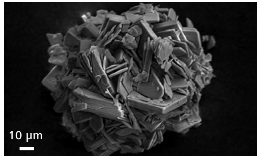
Imaging C2D con effetto di carica drasticamente ridotto (campione: carbonato di lantanio, un legante di fosfati utilizzato come agente terapeutico orale per i pazienti in dialisi).
