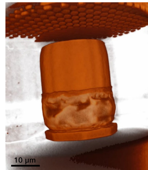
铜微凸块和互连的可视化及缺陷检测。使用 Xradia 800 Ultra 成像。
