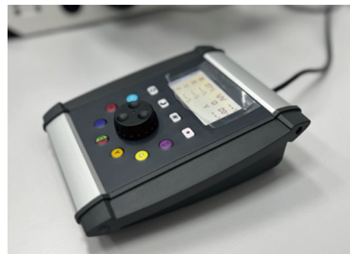
Die Bedienkonsole von Viluma 5/7 ermöglicht schnelles Umschalten der LED-Wellenlängen und eine exakte Anpassung der Lichtintensität.
