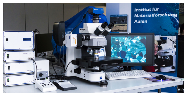
Abbildung 4: ZEISS Axio Imager.Z2m und Peripheriegeräte (Scanningtischsteuerung SMC 2009, HXP 120C, Colibri.2, Hardware Auto Focus) zur Bildaufnahme in Hellfeld- und Polarisationslichtbeleuchtung.
