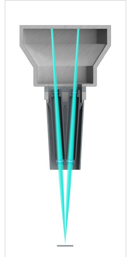
Greenough 光路设计的体视显微镜光路示意图
