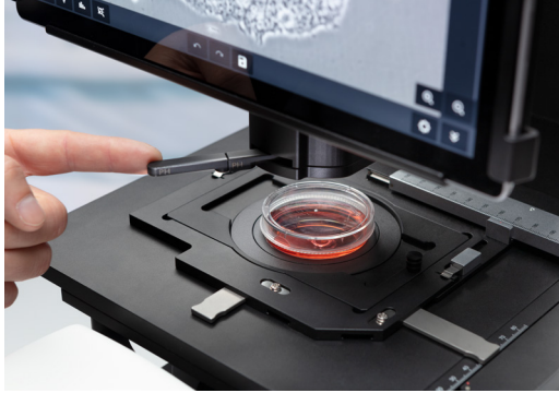
Faz kontrastı ve aydınlık alan arasında geçiş yapmak için kontrast kaydırıcıyı kolayca hareket ettirin.
