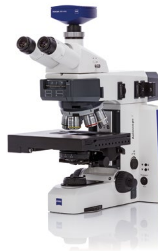
ZEISS Axioscope Microscopio codificato e motorizzato per ricerche sui materiali e attività di routine ad alta produttività
