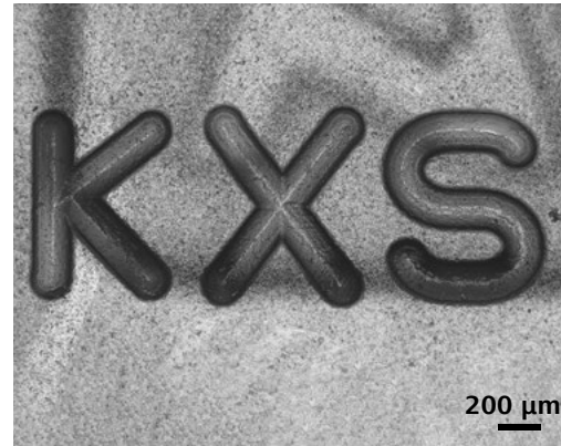
Lettera di identificazione stampata a iniezione su una parte in plastica trasparente, EC EPIPLAN 5x/0,13
