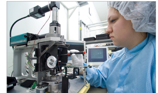
Die Pankrat-Justiervorrichtung erstellt die individuelle Zoomkurve Ihres eZoom auf der Basis von rund 7.000 Stützstellen.
