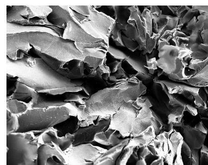
引張破損後の鋼の破面。 試料ご提供：The Test House, Cambridge
