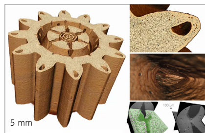
アディティブマニュファクチャリングで製造されたアルミニウム部品（左）およびその内部空隙の画像（右）を示す 3D スキャン。X線顕微鏡でイメージング。
