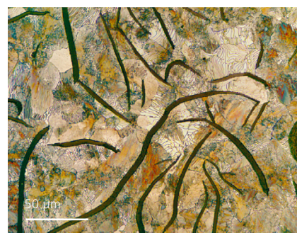
鋳鉄内のグラファイトフレークをエッチングした試料。 画像ご提供：University of Applied Sciences, Aalen, Germany
