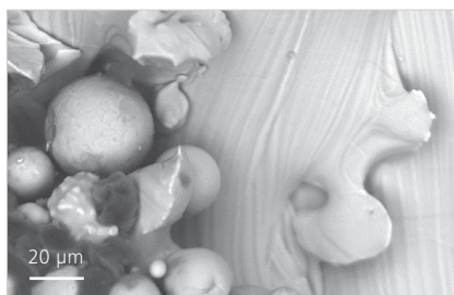
アディティブマニュファクチャリングで製造されたチタン合金部品の表面。試料ご提供：TWI Ltd
