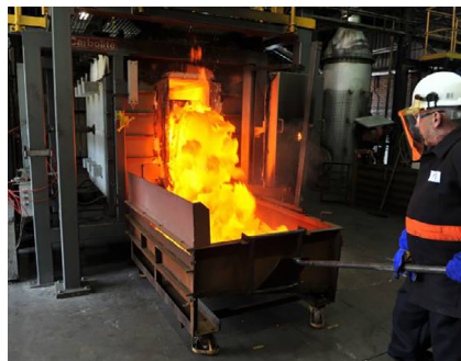
英国・ミドルズブラの材料加工施設で 50 kg のコークス炉を押している様子。写真ご提供：The Materials Processing Institute, UK
