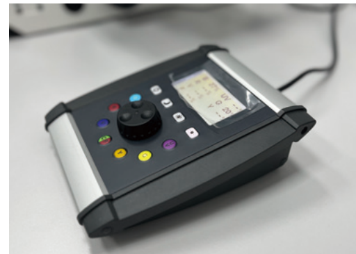
El panel de control de iluminación de Viluma 5/7 permite conmutar con flexibilidad entre distintas longitudes de onda LED, con un ajuste preciso de la intensidad.
