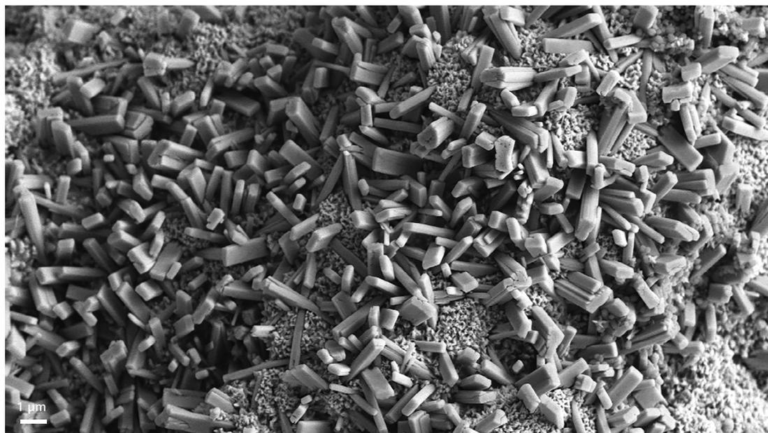
デンドライト構造酸化亜鉛のこの画像は、エネルギー貯蔵システムの電極の形態変化の検出に役立ちます。Sigma で ETSE 検出器を使用した二次電子イメージング。
