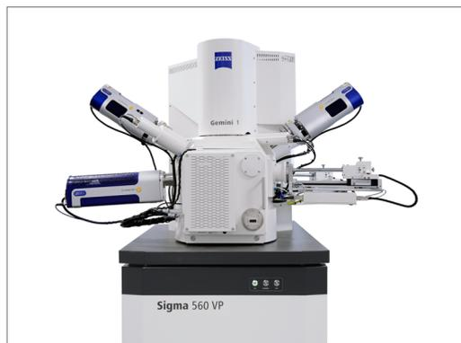
ハイスループットな解析のために構成された Sigma 560 を使用すれば、トポグラフィーや組成に関する情報を取得できます：同一平面上に 2 つの EDS 検出器が設置されており、一方が化学元素に関する情報用で、他方が結晶学用の EBSD カメラです。
