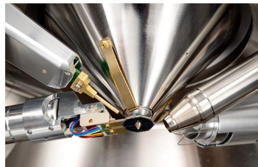
環状 BSE 検出器 (aBSD) が対物レンズのポールピースの下に取り付けられたチャンパー内部。これにより、低真空 (NanoVP lite モード) イメージングと表面 3D 再構築 (3DSM) が可能に。
