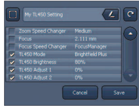
可以使用 SYCOP 3 保存整个设备配置，其中包括透射光照明设置；需要时，只需点击按钮便能还原已保存的设置。
