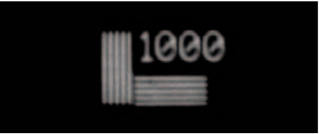
SteREO Discovery.V12 与 PlanApo S 2.3x 物镜组合应用能够获得高达 1000 线对/毫米 (LP/mm) 的分辨率。
