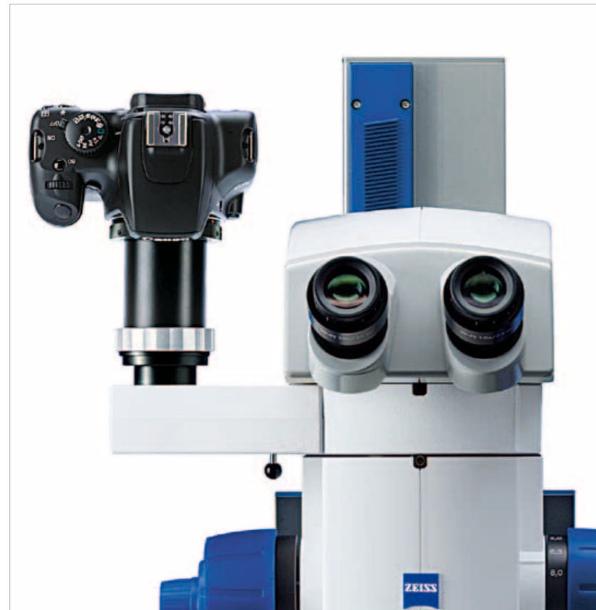
SteREO Discovery.V8, 配有一台安装于 intermediate photo tube S 中间成像镜筒, 左侧 100/100 照相端口上的 Canon EOS 1000D 相机
