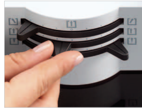
三个控制杆可调节反光镜相对于样品的位置。
