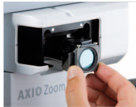
锁位功能：Z 型反射光模块能轻松快速地插入 Z Fluar 荧光照明器中。
