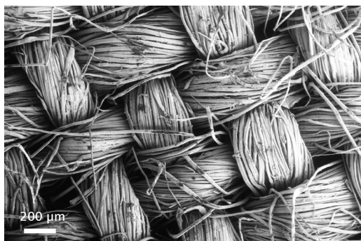
Le C2D produit d'excellentes images d'échantillons non métallisés, en mode pression variable, qui conviennent parfaitement à la comparaison médico-légale de fibres.
