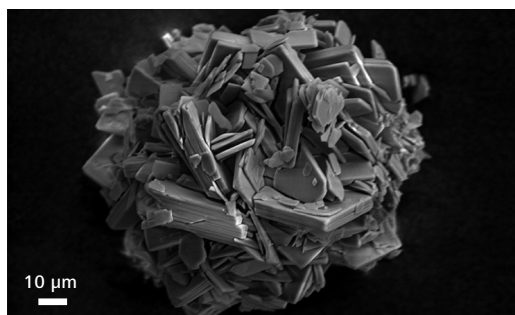
Imagerie C2D avec effet de charge drastiquement réduit (Echantillon : carbonate de lanthane, un liant de phosphate utilisé comme agent thérapeutique oral pour les patients sous dialyse).
