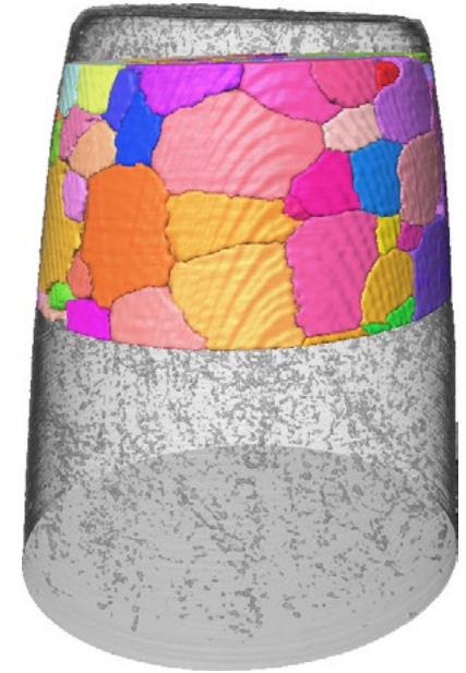
显示吸收和晶粒信息的 Al 4 Cu 合金。由日本丰桥技术科学大学的小林正和教授提供。
