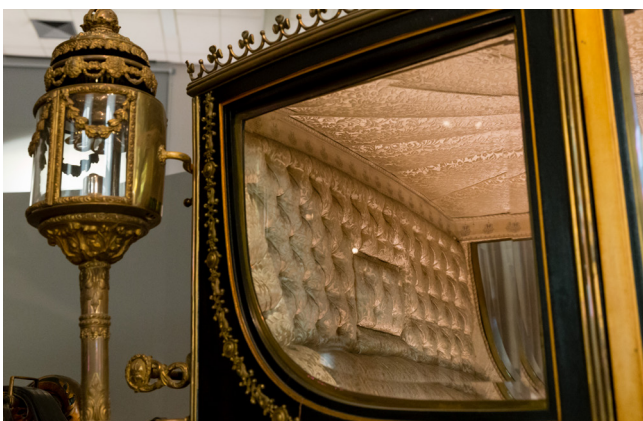
Abbildung 7 Aufbauten aus mit Blattgold überzogenem Holz, Fenster aus Glas, gepolstertes Interieur, Stickereien, die Zugvorrichtung aus Metall, Gemälde auf dem Holz – eine Kutsche ist ein Zusammenspiel verschiedenster Materialien.
