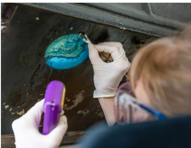
Abbildung 4 Test des geeigneten Lösungsmittels mit Hilfe der UV-Lampe.
