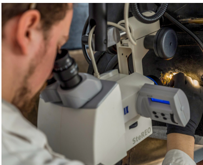
Abbildung 5 & 6 Das Stereomikroskop ZEISS SterEO Discovery.V8 mit Bodenstativ erlaubt die bequeme Arbeit im Sitzen auch bei größeren Objekten.
