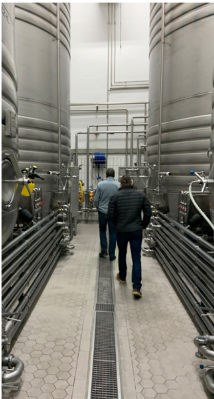
Abbildung 4 Vier Tanks mit je 120 Hektolitern Fassungsvermögen ermöglichen die separate Produktion der neuen Weißbiersorten.
