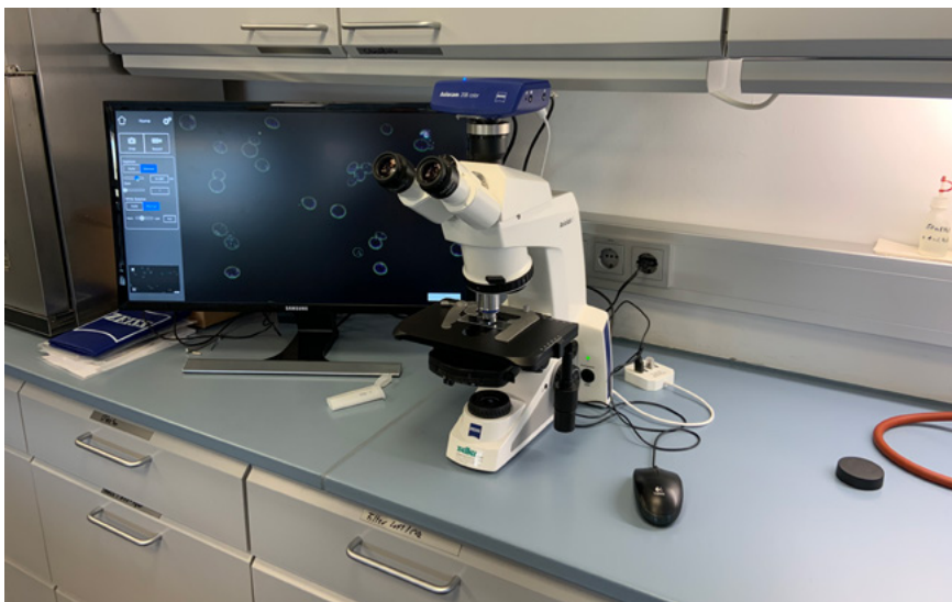
Abbildung 9 Das Labormikroskop ZEISS Axiolab 5 liefert kontrastreiche Bilder der Bierhefen.
