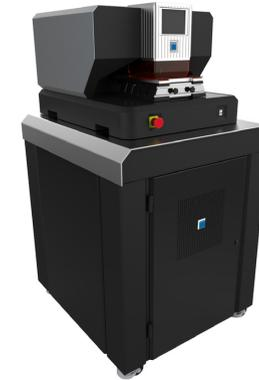
*Der ESI NWR213 Ablationslaser erkennt Datenausgaben von ZEISS Mineralogic 2D ohne Konvertierung. Mit einem 4 µm großen Laserpunkt und einer Repetitionsrate von 20 Hz ist dieser Nd:YAG-Laser ideal für die Analyse geowissenschaftlicher Proben geeignet, z. B. für Erze in harten Gesteinen, Zirkone und vieles mehr.*
