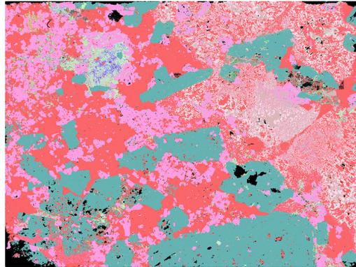
Peralkaliner Granit, Nord-Québec (Kanada) mit Seltene-Erden-Anteilen, einschließlich einer Fluoritader, die die Probe durchschneidet, und abgegrenztem Zirkon.
