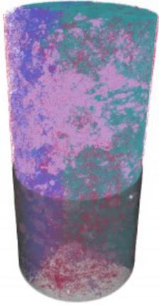
Mineralogic 3D combina la tomografía de rayos X con el aprendizaje automático avanzado para proporcionar una medición auténtica de la muestra sin fases de interés ocultas
