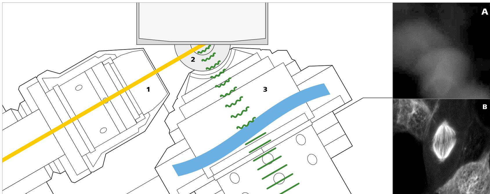
概要：サンプルキャリアと光学系。励起用対物レンズ (1)、メニスカスレンズ (2)、free-form optics を有した検出用対物レンズ (3)。(A) は、屈折率補正なしの画像例、(B) は、屈折率補正ありの画像例。
