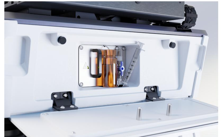
ZEISS Lattice Lightsheet 7 オートイメージョン供給装置
