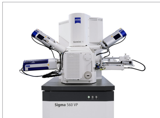
为通量分析配置的 Sigma 560，获得了关于形貌和成分的信息：两个共面 EDS 探测器用于化学元素的信息，一个 EBSD 探测器用于晶体学分析。
