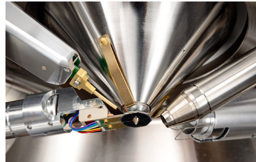
样品室一览：环形背散射电子探测器（aBSD）安装在物镜的极靴下，能够在可变压力（NanoVP lite 模式）和三维表面建模（3DSM）下成像。
