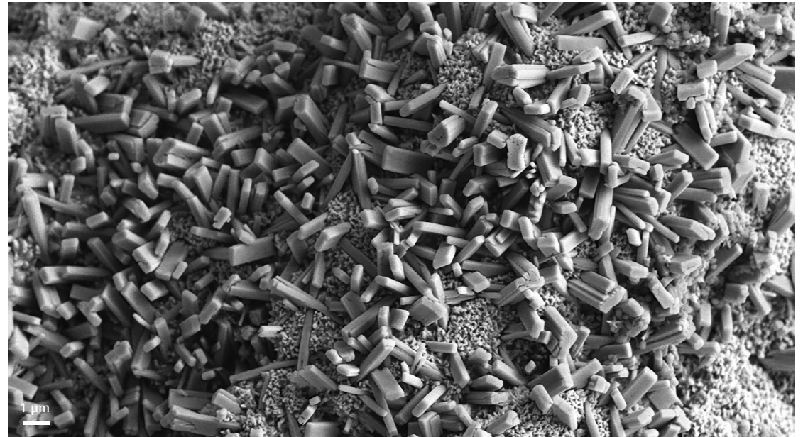
该图像为氧化锌树突，有助于检测储能系统电极的形态变化。使用 Sigma 上的 ETSE 探测器进行二次电子成像。
