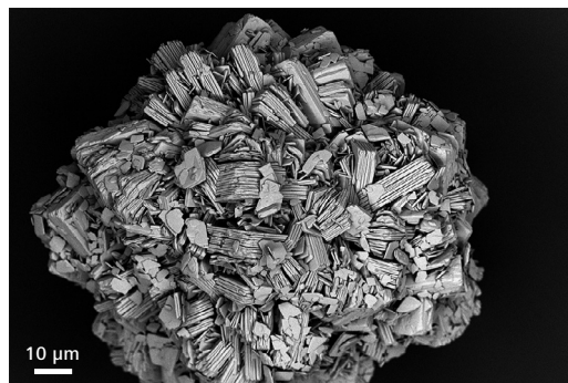
在 1 kV 下，使用 InLens Duo 探测器 BSE 模式下对碳酸镧成像。 \text{LaCO}_3 作为一种磷酸盐粘合剂，可用作透析患者口服治疗药剂。
