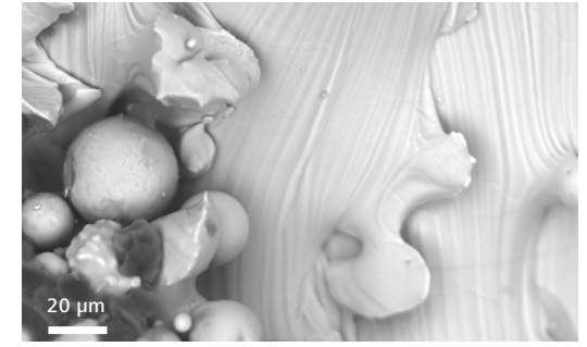
Titanyum alaşımının (Ti-6Al-4V) yüzeyi, seçici lazer eritme kullanılarak katmanlı imalat tekniğiyle üretilmiştir, erimemiş Ti-6Al-4V partiküllerine ve diğer malzemelere ek olarak tamamen erimemiş bölgeleri göstermektedir. BSE dedektörü ile EVO 15'te görüntülenmiştir. Numune TWI Ltd. tarafından verilmiştir.
