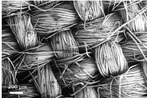
C2D, değişken basınç modunda kaplamasız numuneleri mükemmel şekilde görüntüler ve adli tıp lif karşılaştırmaları için çok uygundur.
