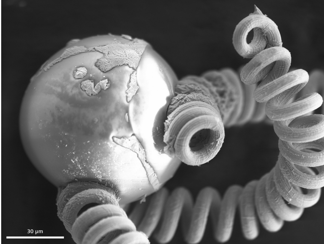
Feci bir patlamada bulunan katılaştırılmış erimiş cam parçaları olayın sebebini bulmak için kullanılabilir. C2D dedektör ile 20 kV, 30 Pa'da görüntülenmiştir.
