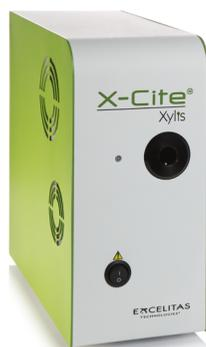
X-Cite Xylis を高速励起フィルターホイールと併用すると、最大 770 nm の長波長試料照明が利用可能に。また、このスグリーンギャップ（LED 蛍光光源の問題）が克服され、このスペクトル範囲は従来のアークランプに匹敵します。
