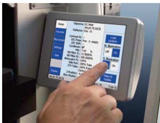
Schalten der Beleuchtung am TFT
