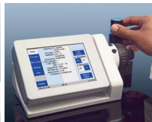
Bedienung der motorischen Tische über die Docking-Station
