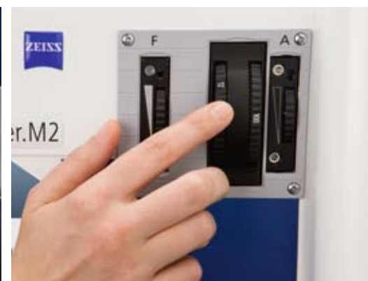
Ideale Anordnung der Blendenschieber und Filtrerräder im Auflicht
