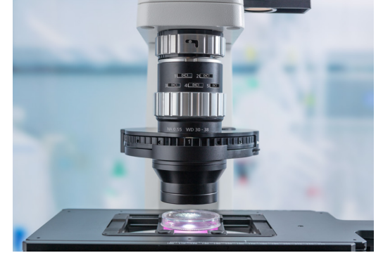
LD kondansatör 0,55, 38 mm'ye kadar serbest çalışma mesafesi sunar.
