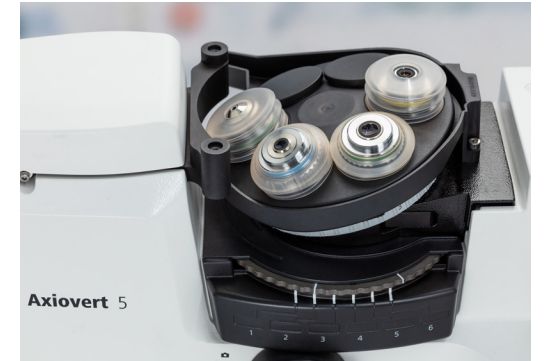
Aqua Stop II, mikroskop içindeki objektifleri ve diğer optik bileşenleri sıvılardan korur.
