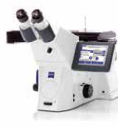
ZEISS Axio Observer オープンでフレキシブルな倒立顕微鏡プラットフォーム。Axio Imagerのすべての機能、光学、イメージングモードを提供。簡単に試料の調製が可能で大型の試料にも対応。
