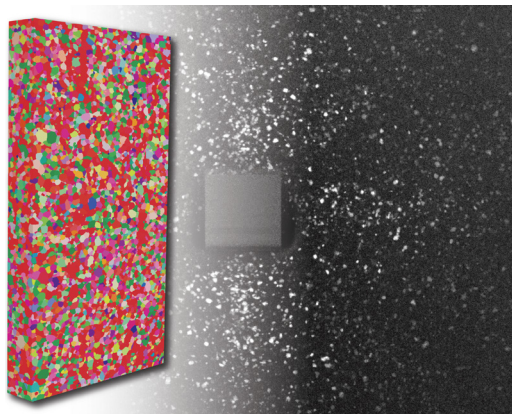
AA5657 样品的 3D 晶粒图，尺寸为 (RD) 4 mm、(TD) 2 mm、(ND) 0.5 mm。图像是使用高纵横比的黄金螺旋扫描样品而得。样品由美国 Novelis 的 Robert Sanders 博士提供。
