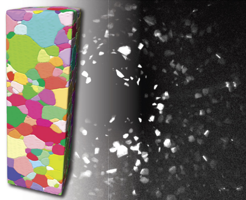
\beta -Ti样品的3D晶粒图，尺寸为（边长）1.0 mm、（高度）3.2 mm。图像是使用黄金螺旋扫描样品而得。
