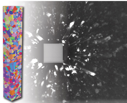
奥氏体不锈钢样品的3D晶粒图，尺寸为（边长）0.66 mm、（高度）4.4 mm。图像是使用带平移的黄金螺旋扫描样品而得。样品由丹麦技术大学的Grethe Wither教授提供。
