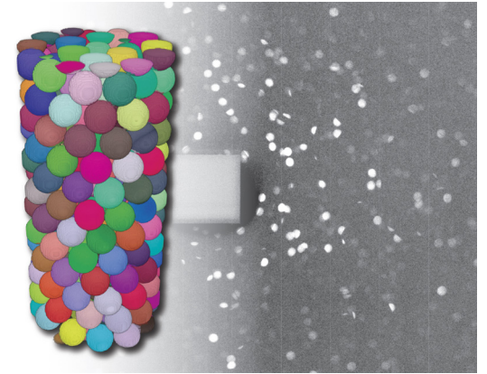
堆叠蓝宝石球体的 3D 晶粒图，单个球体直径为 0.2 mm。图像是使用黄金螺旋扫描样品而得。
