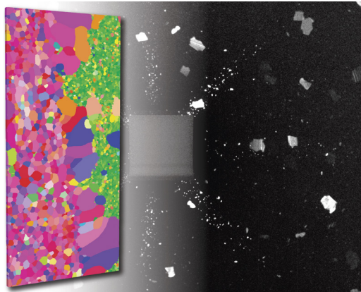
超薄取向电工钢样品的 3D 晶粒图，尺寸为 (RD) 4 mm、(TD) 2 mm、(ND) 0.08 mm。图像是使用高纵横比的黄金螺旋扫描样品而得。样品由中国钢研科技集团的 Li Meng 博士提供。
