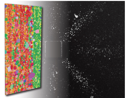
超薄取向电工钢样品的 3D 晶粒图，尺寸为 (RD) 4 mm、(TD) 2 mm、(ND) 0.08 mm。图像是使用高纵横比的黄金螺旋扫描样品而得。样品由中国钢研科技集团的 Li Meng 博士提供。
