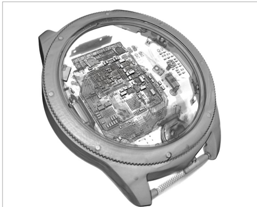
在 28 μm/ 体素下成像的智能手表三维渲染图。图像显示了整个手表部件及内部特征，如主板和声音组件。
