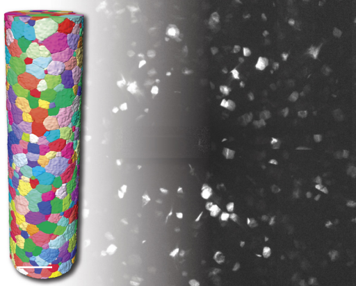
铝-4wt.%铜样品的3D晶粒图，尺寸为（直径）1.1 mm、（高度）5.1 mm。图像是使用黄金螺旋扫描样品而得。
