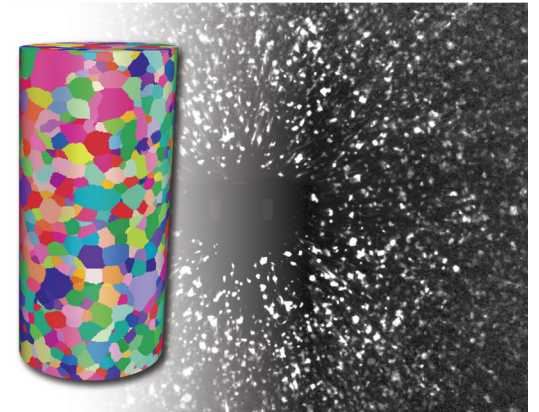
高纯铁样品的3D晶粒图，尺寸为（直径）1.0 mm、（高度）3 mm。图像是使用带平移的黄金螺旋扫描样品而得。样品由美国佛罗里达大学的Burton R. Patterson教授提供。
